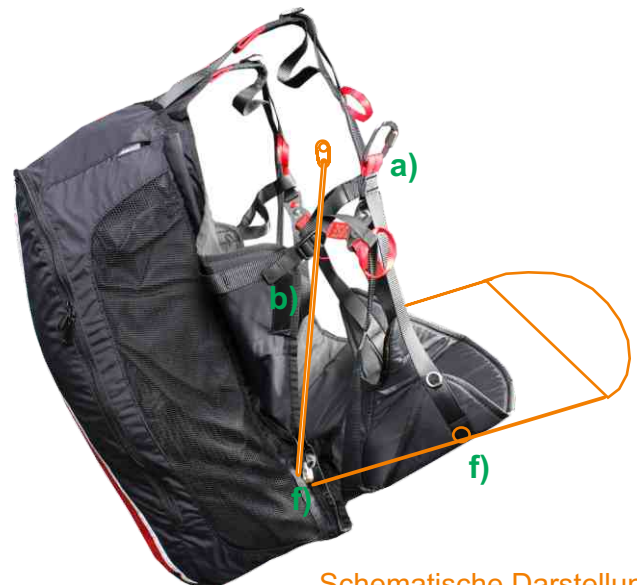
Schematische Darstellung Einbau Beschleuniger
